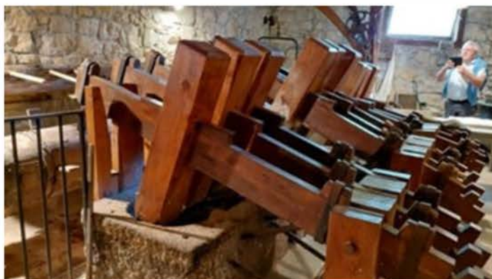
Pile à maillets pour le raffinage des chiffons dans les moulins à papier; Cuves granit. Arbres en chêne et métal sur paliers en silex. Provenance probable : Ambert (XVIe siècle)
